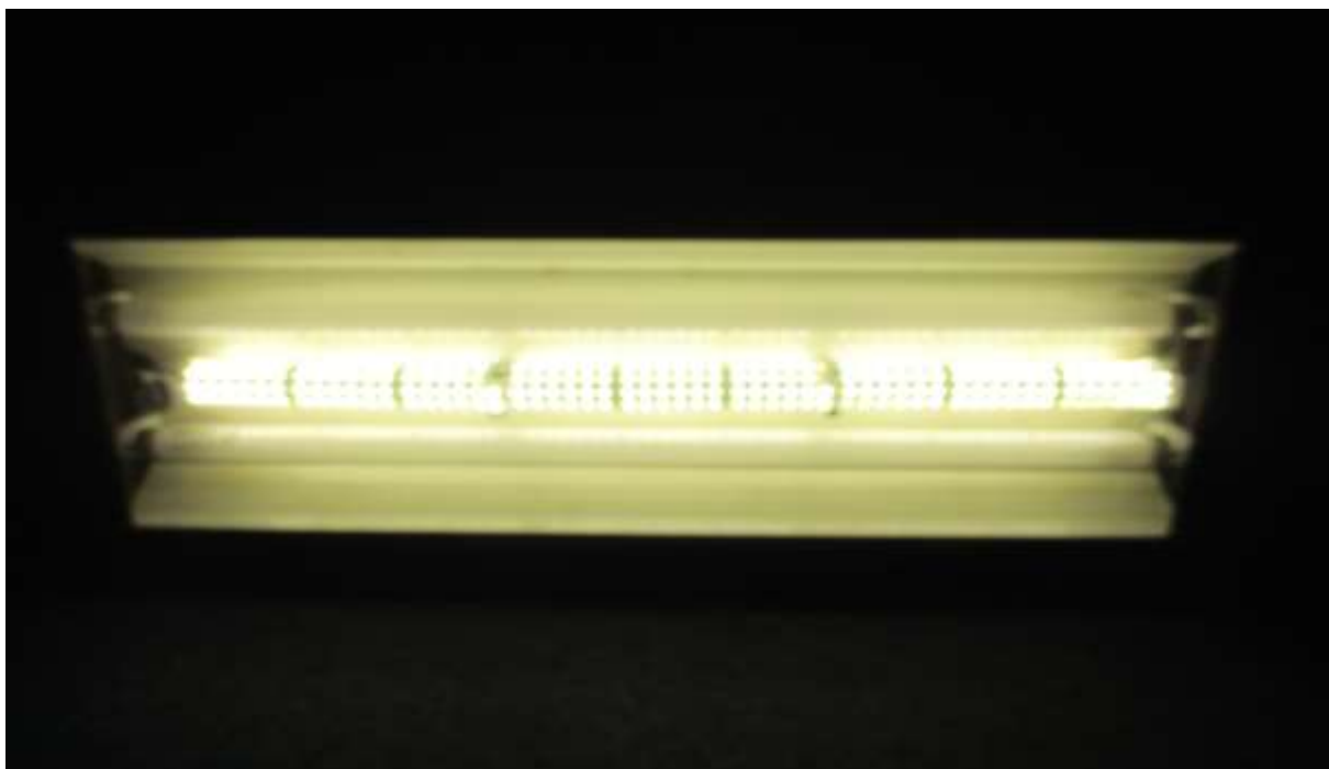
Figure 2. Les deux T1 sont bien allumés , nous pouvons donc constater que la composition de 9 Modules polyvalents de 850 Lumens chacun, produise 7650 Lumen. Soit 4 fois plus que TL standard. Un seul module polyvalent de lumière blanche froide représente 6270°K équivalant au blanc 33
